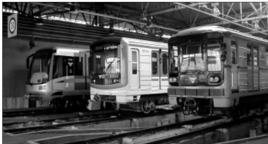
Tři soupravy pražského Metra dokumentují technický vývoj. Nejstarší souprava z počátku sedmdesátých let vpravo bude nahrazena vozy rekonstruovanými ve Škodě Plzeň, z nichž zůstává původní pouze podvozek a skříň a zcela novými vozy z ČKD (vlevo). Více informací - v sekci věnované dopravě na EEBW 2000.
